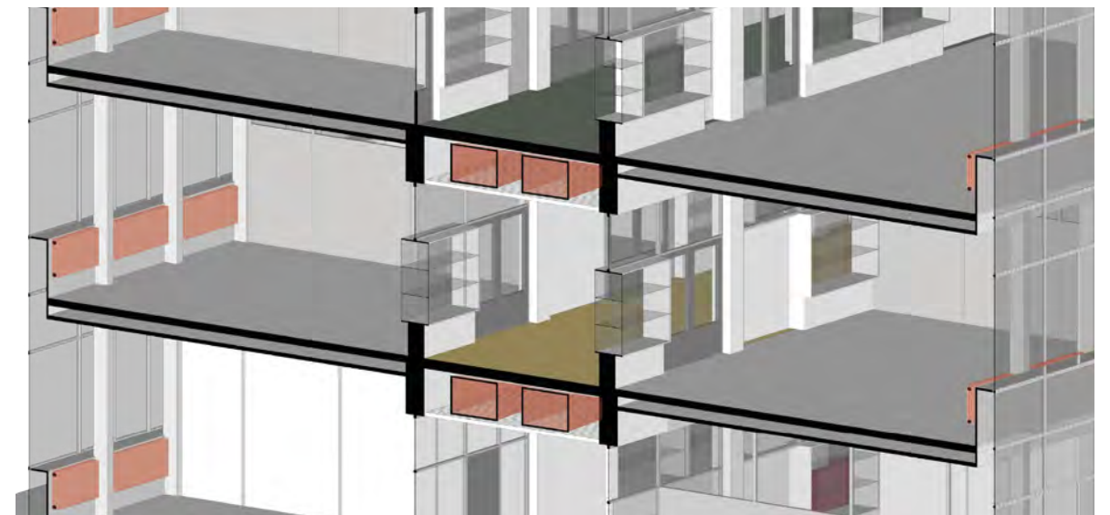
25. Ruimtelijke inpassing installaties - radiatoren langs de gevel, kanalen boven plafond middengang, image WDJJA
