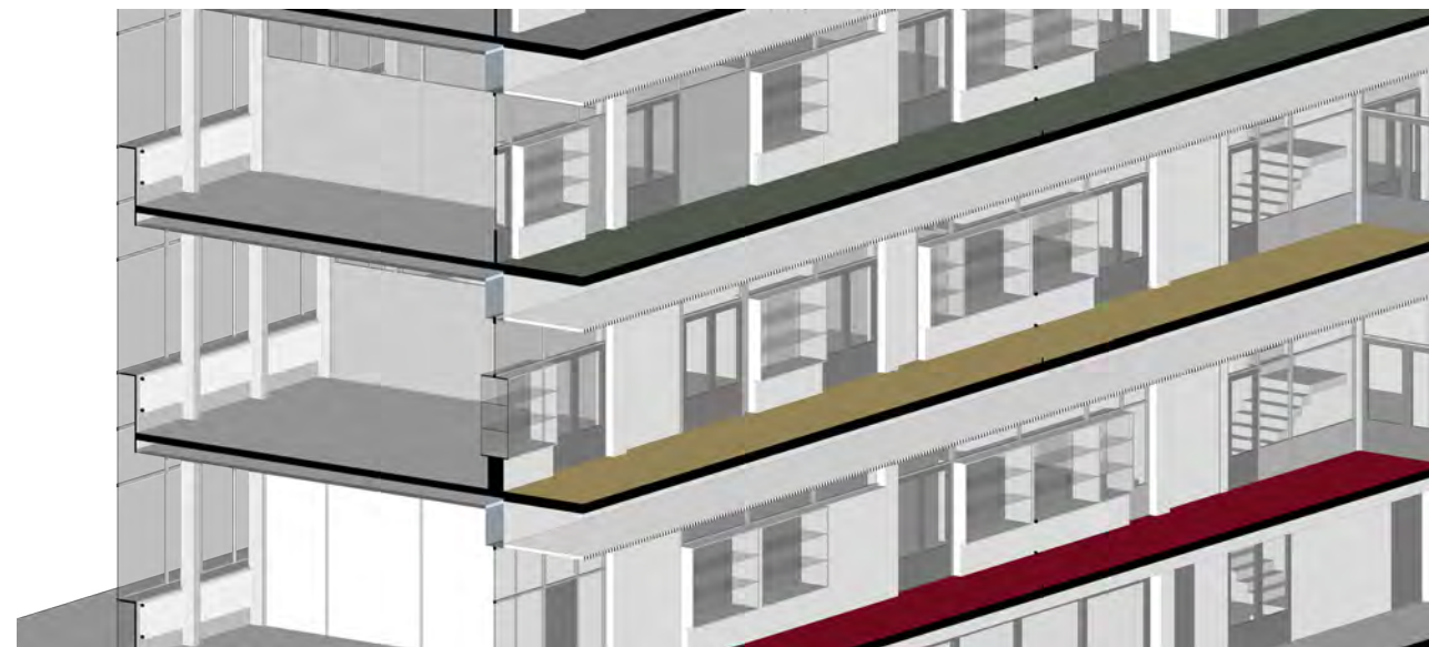
47. Interieur lokalen en middengang; hoge mate van transparantie door binnenwanden en borstwering, afbeelding WDJ A
