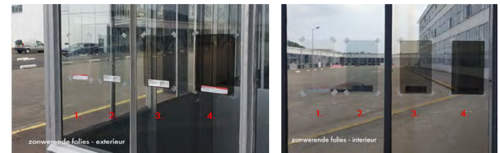
Proefopstelling zonwerende folies (testlocatie Van Nellefabriek, Rotterdam). Links gezien vanaf buiten en rechts vanaf binnen. De samples zijn van ca. A4-formaat.
