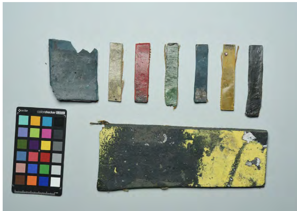
Fig. III.2.3: Bouwhistorische fragmenten van het marmoleum, kurklinoleum en het plasnalo dat in tijdens de restauratie in 2002 uit de Rietveld Academie werd verwijderd. Dit materiaal is nu gearchiveerd in het archief van de Rietveld Academie.
