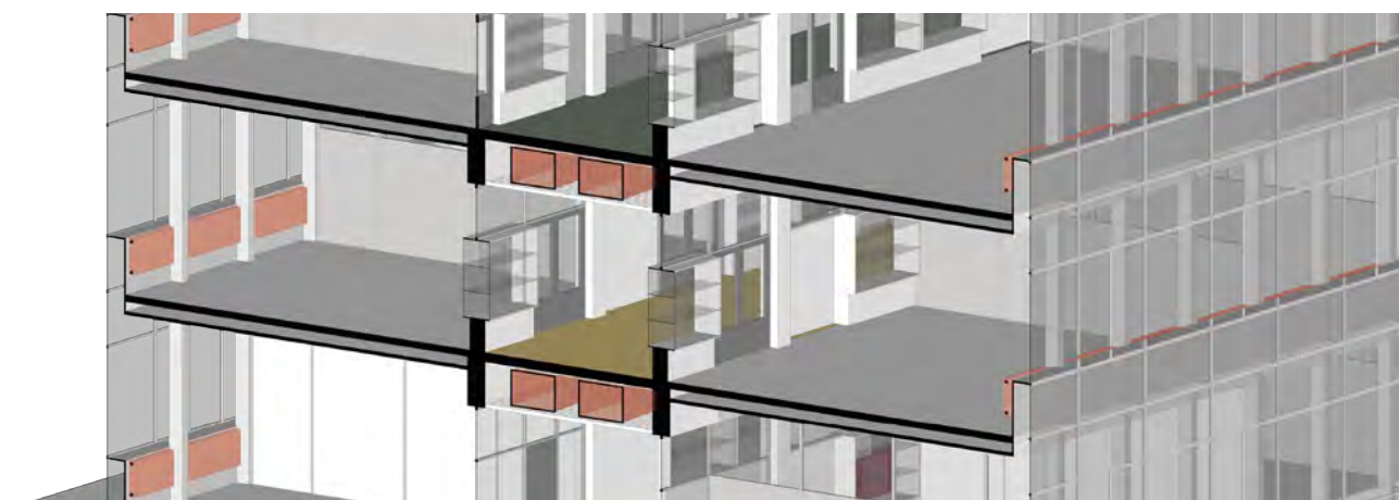
70. Ruimtelijke inpassing installaties - radiatoren langs de gevel, kanalen boven plafond middengang, afbeelding WDJJA
